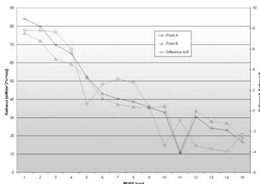
**Figura 6.** Representación de los datos de reflectancia en las 15 bandas del sensor MERIS para los puntos A y B de la Figura 5. Los valores muestran características de aguas abiertas para el punto B y aguas caso II para el punto A.
