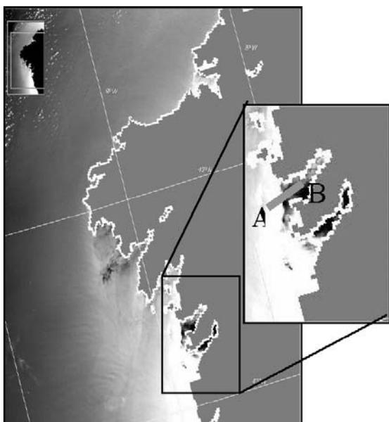
**Figura 5.** Banda 6 de MERIS donde se observa una menor reflectancia en las Rías de Vigo y Pontevedra, así como en la boca de la Ría de Muros. Valores mínimos que corresponden con los máximos de células de *Pseudo-nitzschia* spp. detectados por el CCMM. La línea entre los puntos A y B es el transecto representado en la Figura 4.
