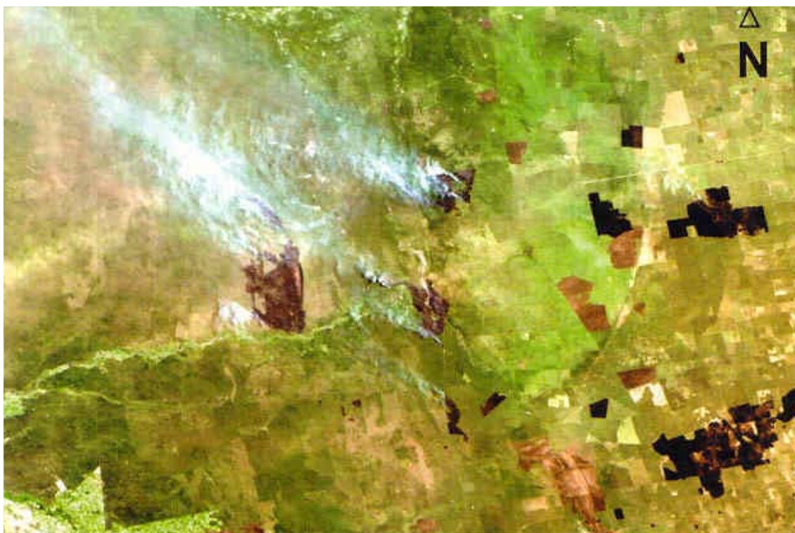
Figura 1. Imagen tomada por el sensor MMRS del SAC-C el 27/12/2000 en una zona que abarca parte de las provincias de Mendoza y San Luis en las que se registran focos de incendio. Se observa en la parte central las columnas de humo de los focos activos. El tamaño de pixel es de 175 metros y se utilizó la banda 4 en el verde para resaltar la vegetación. Escala aproximada 1:1.200.000.
