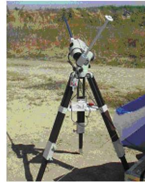
Figura 3: Espectrorradiómetro FieldSpec Pro FR.
