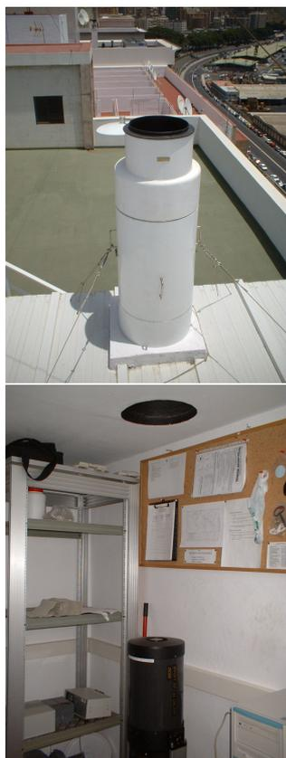
Figura 1: *Instalación del lidar MPL en Santa Cruz de Tenerife. La fotografía superior muestra la chimenea exterior que protege de la incidencia solar directa. La compuerta superior se encuentra abierta en el momento de tomar la fotografía. Abajo se muestra el telescopio del lidar en el laboratorio.*
