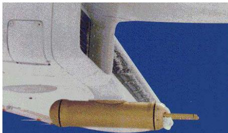
Figura 2 . Sonda OAP-2D2-C instalada bajo el semiala izqda, realizando medidas en nubes en tiempo frío.
