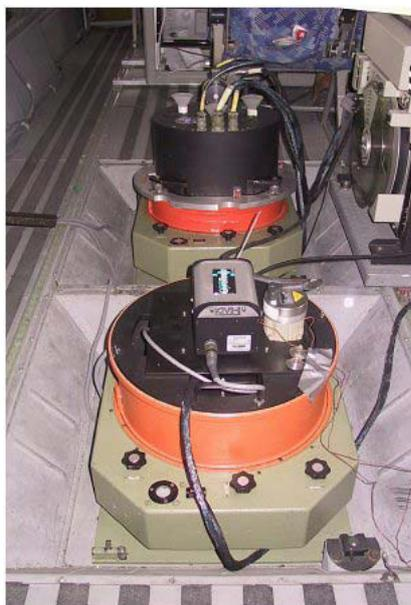
Figura 3.. Interior de la cabina con los sensores ATM y AMDC instalados
