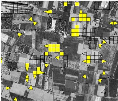
Figura 5.- Detalle de la eliminación de algunos píxeles (cuadros rellenos) que se clasifican erróneamente como urbanización en zonas de huerta, mediante la umbralización del NDVI de una fecha posterior.
