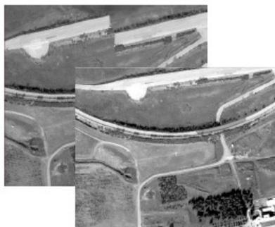
**Figura 6.-** Detalle del mosaico del bloque INTA antes y después de la calibración (mosaico de ortoimágenes de 0.5 m de resolución).
