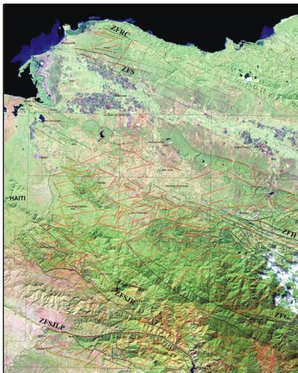
Figura 3. Mosaico Landsat 7 (fusión 541-P) del bloque Noroeste con indicación de las unidades morfoestructónicas y las grandes zonas de falla
