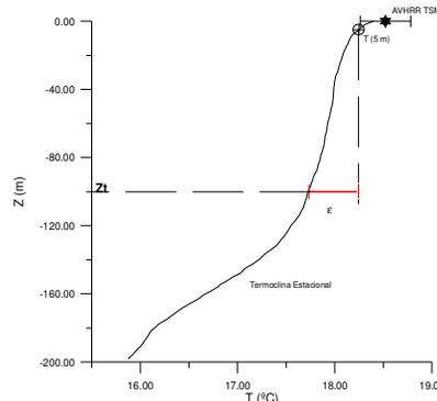
**Figura 1: Esquematación de la relación entre la temperatura medida por el AVHRR (estrella) y la temperatura de la columna de agua y el nivel de precisión que se obtiene.**
