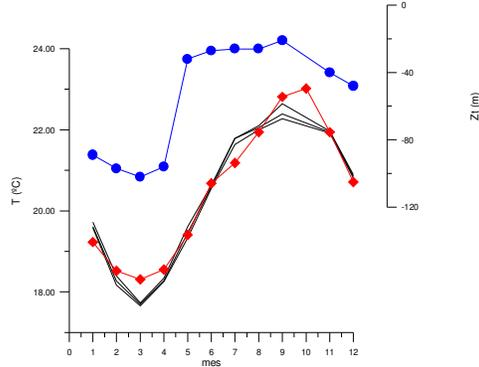
Figura 2: Patrones anuales de temperatura: para 0, 5 y 10 m en líneas continuas y para el AVHRR con rombos. Sobre el eje derecho y con círculos: profundidad de la capa homogénea respecto a  $T_{5m}$  para  $\epsilon=0.5^{\circ}C$ .
