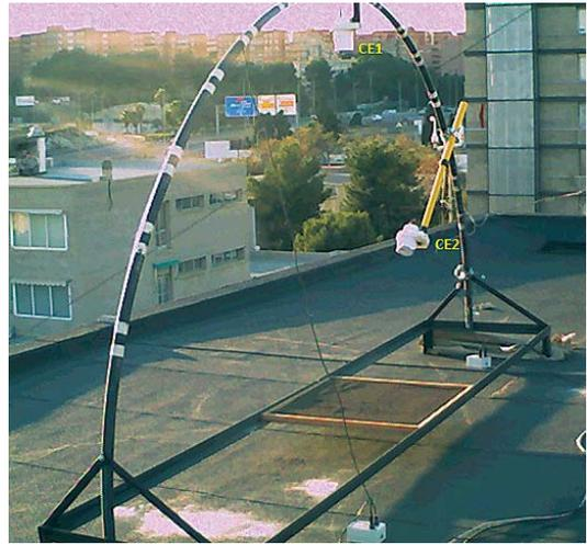
**Figura 1.** Fotografía del montaje experimental en el momento de medir simultáneamente un SDI a nadir (CE1) y a un ángulo cenital (CE2).
