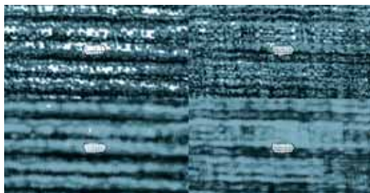
Figura 5. Arriba izquierda, filtro textural del Segundo Momento Angular para ventana 3x3 y desplazamiento 1,1. Arriba derecha, filtro textural del Segundo Momento Angular para ventana 3x3 y desplazamiento 1,9. Abajo izquierda, filtro textural del Segundo Momento Angular para ventana 7x7 y desplazamiento 1,1. Abajo derecha, filtro textural del Segundo Momento Angular para ventana 7x7 y desplazamiento 1,9.
