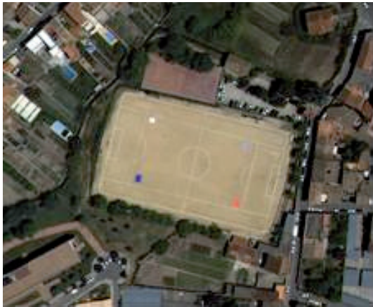
Figura 1. Fotografía aérea del campo de calibración ICC en Banyoles (2005). Blanco radiométrico empleado en la parte superior izquierda del campo (cubierta blanca sobre suelo).
