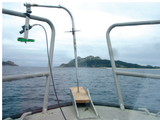
Figura 2. Fotografía del soporte fijado a la proa de la embarcación con la fibra óptica del espectrorradiómetro ASD FieldSpec FR y la superficie lambertiana del 25%.
