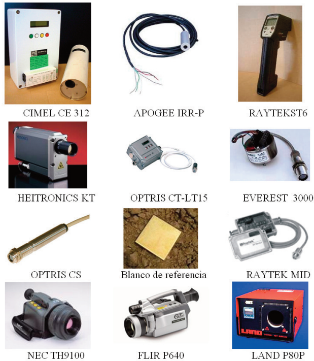
Figura 2. Instrumentación utilizada en las medidas en el infrarrojo térmico
