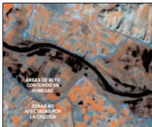
Figura 8. Discriminación entre áreas con alto contenido en humedad (en tonos oscuros) y áreas no afectadas por la crecida
