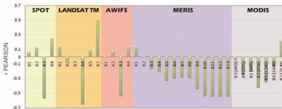
Figura 3. Correlación entre las bandas de los sensores y la severidad de las parcelas observada en campo (para mayor claridad, las bandas de MODIS han sido ordenadas según las longitudes de onda correspondientes).
