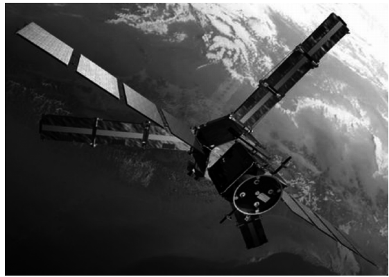
*Figura 1. Visión artística del satélite SMOS, con los tres brazos desplegados en forma de Y que contienen los 69 elementos de la antena del radiómetro interferométrico (realizada por ESA Medialab).
