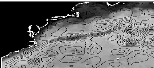
Figura 4. Superposición de las curvas de nivel de un mapa altimétrico sobre la FCMS derivada de SST analizada en la zona de cabo Hatteras. La imagen de SST original fue obtenida el 31 de Diciembre de 2003.
