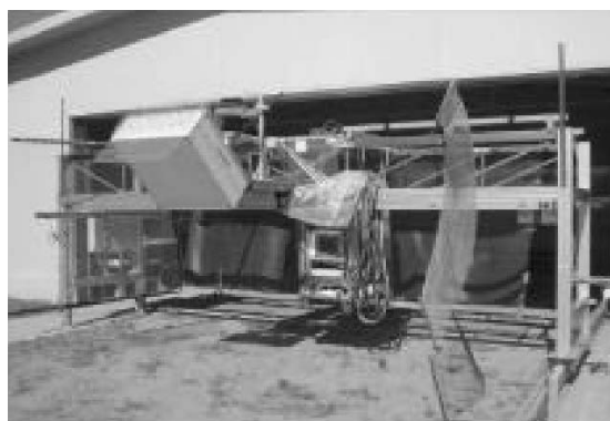
Figura 3. LAURA montado en un caballete deslizable, para tomar medidas en cada campo.
