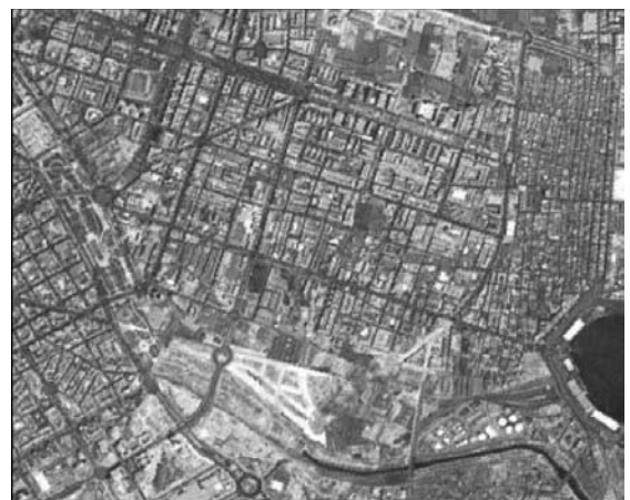
Figura 11. Detalle de la imagen IRS de 1996 resultado de la fusión por el método de sustitución basado en el cálculo de los componentes principales.
