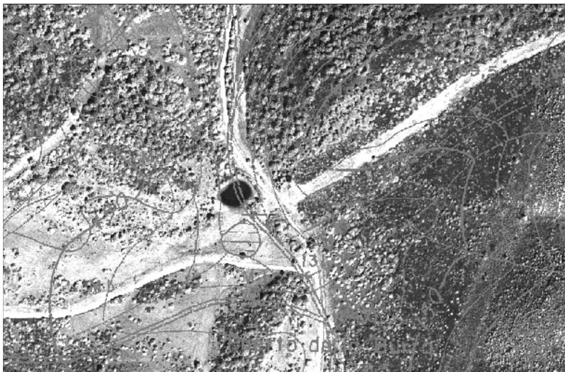
Figura 3a. Superposición de la imagen Ikonos Geo pancromática con el Mapa Topográfico de Andalucía escala 1:10.000. En esta figura puede observarse el grado de desajuste geométrico entre ambas coberturas. Escala de la figura 1:5.000.
