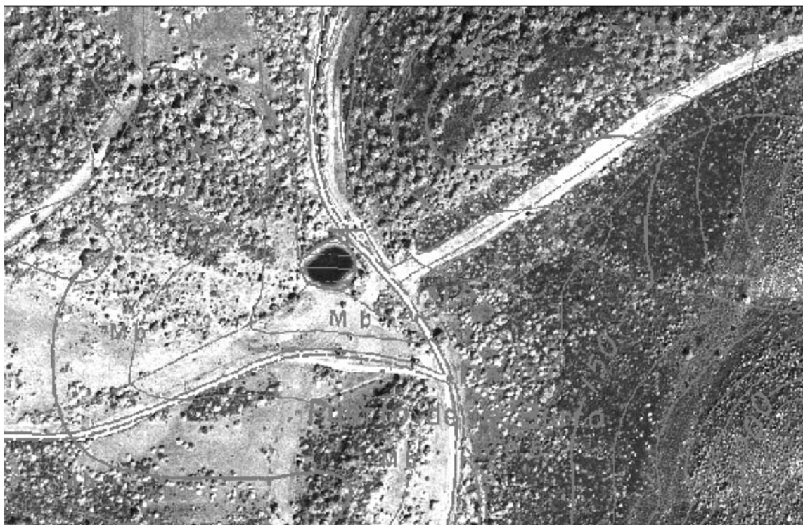
Figura 3b. Superposición de la imagen Ikonos pancromática ortorrectificada con el Mapa Topográfico de Andalucía escala 1:10.000. El nivel de precisión geométrica logrado se considera aceptable para la metodología que se sigue en este proyecto. Escala de la figura 1:5.000
