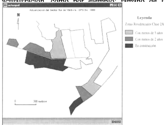
Figura 6. Mapa vectorial obtenido a partir del ingreso de coordenadas GPS pertenecientes al sistema de referencia SAD-69, procesadas con IDRISI
