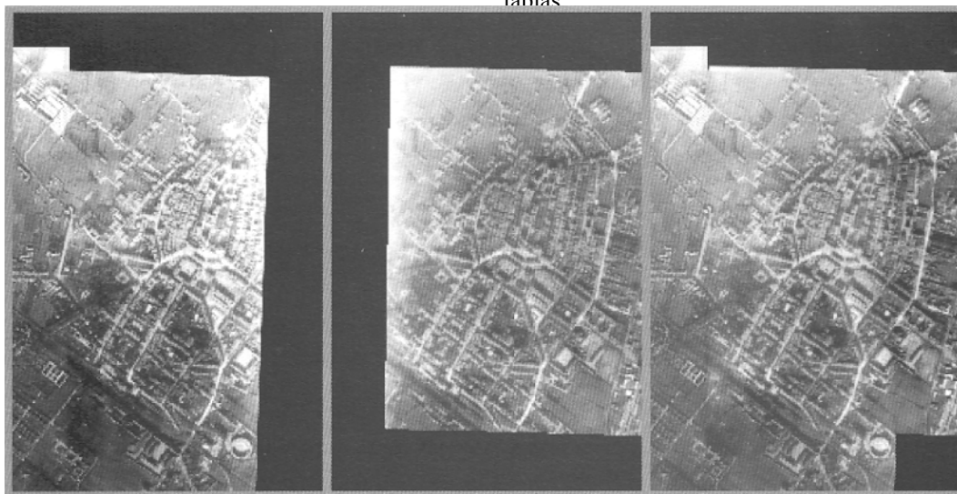
Figura 4. Generación de imagen mosaico en la zona de superposición. a) Información de la primera imagen en un entorno de la zona de superposición. b) Información correspondiente a la segunda imagen. c) Imagen fundida.
