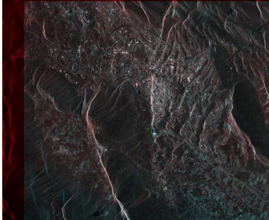
Figura 105 (arriba): Superposición de dos imágenes radar (SAR) adquiridas por la constelación COSMO-SkiMed antes y después del terremoto de L'Aquila (Italia), de intensidad 6,7 en la escala de Richter. La previa se tomó el día 22 de marzo de 2009 y la posterior el día 9 de abril de 2009. Las zonas verdes se han mantenido estables. En azul se observan las zonas que han sufrido daños, más o menos significativos, a consecuencia del terremoto. Hubo 294 muertos.
