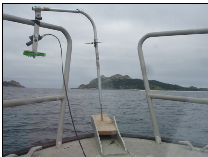
Fig. 2. Fotografía del soporte con la fibra óptica situado en la proa de la embarcación.
