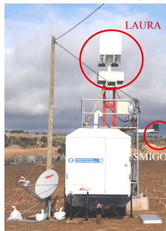
Figura 3.- Instalación del radiómetro LAURA y el reflectómetro SMIGOL sobre plataforma elevadora.
