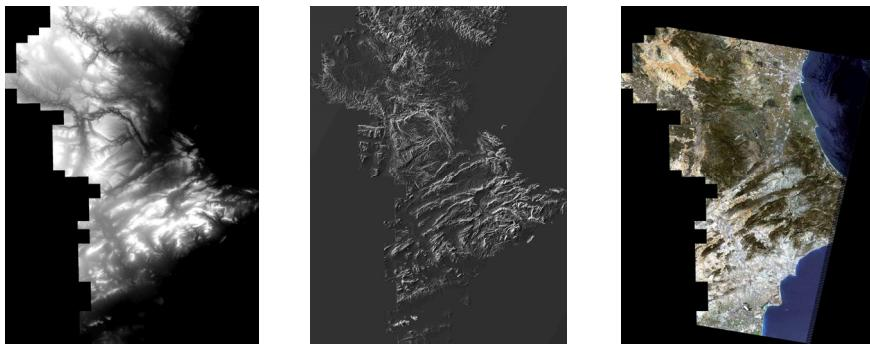
**Figura 2.-** Modelo digital de terreno de 5 m de resolución (izquierda). Coseno del ángulo de iluminación y la normal a la superficie ( $\mu_{hi}$ ) calculado empleando el MDT para cada adquisición (centro). Imagen final corregida atmosféricamente teniendo en cuenta la elevación del terreno y la iluminación (derecha).
