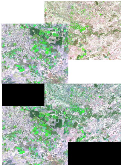
Figura 2.- Dos imágenes Landsat TM de 24 de Junio y 3 de Julio del año 2007 (superior), junto al mosaico resultante aplicando correspondencia de histogramas y suavizado de bordes (inferior).
