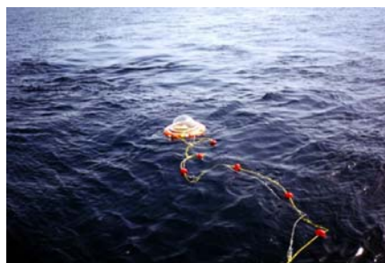
Figura 1: Boya GPS sobre el agua
