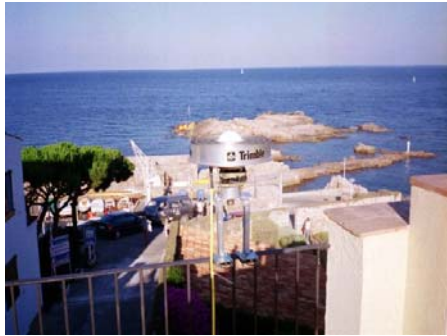
Figura 2: Estación de referencia GPS temporal BEGU
