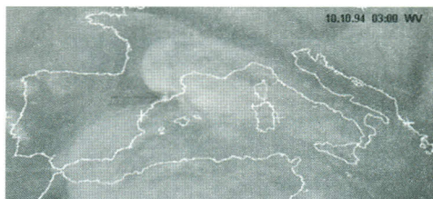
Figura 7. Imagen del canal WV. Detección del overshooting
