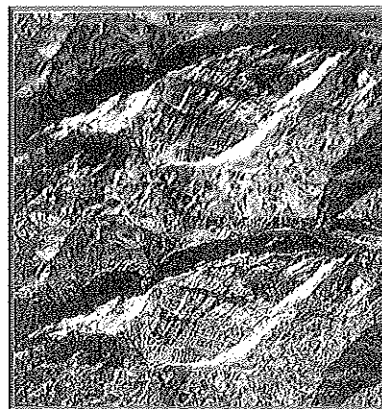
Imagen 6.- Resultado de la suma a la imagen original de un filtro direccional (Edgesenh+cosh) para realzar la red de diaclasamiento del Torcal de Antequera.
