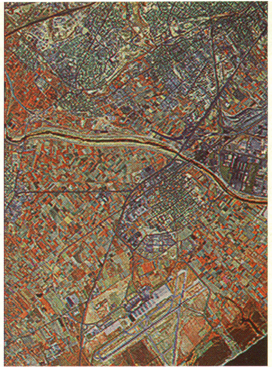
Fotografía 3. Imágenes en falso color sobre el aeropuerto de Barcelona. La imagen de la izquierda corresponde al obtenido con los canales 4, 5, 1 originales, mientras que la de la derecha corresponde al resultado del tratamiento definitivo.
